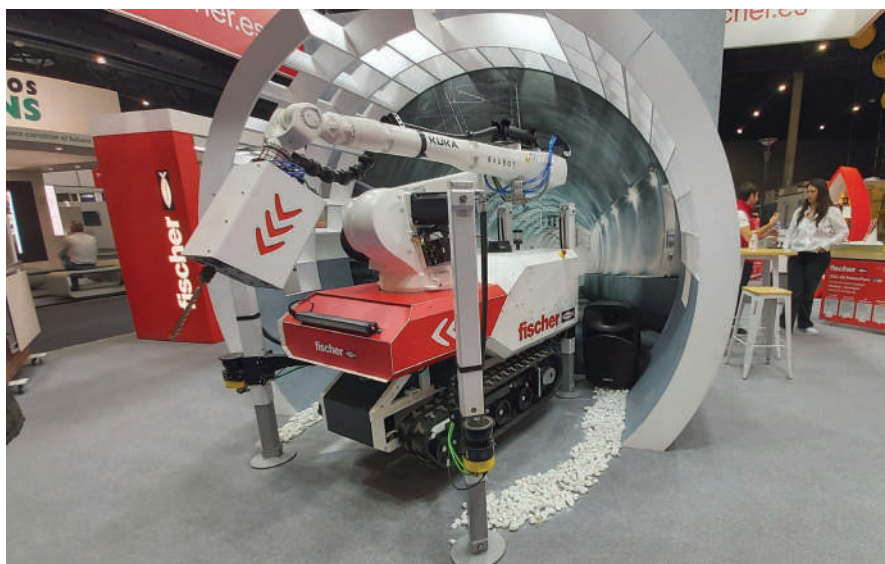
El robot de la multinacional Fischer per a tasques d'ancoratges en treballs de rehabilitació
