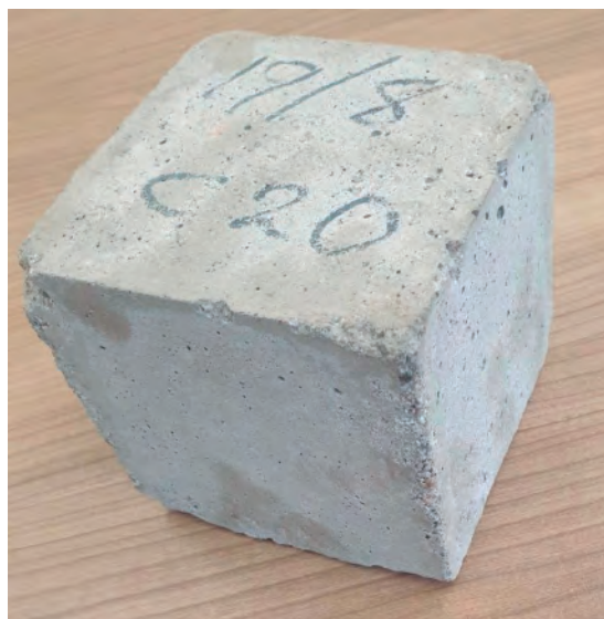
Bloc de formigó que substitueix un 10% de ciment. Imatge cedida per Thermal Recycling
