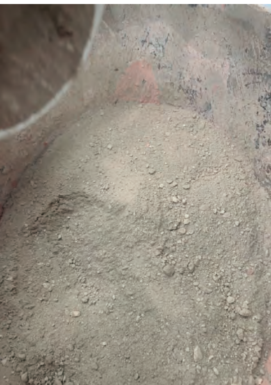
Calmag , el producte resultant de la coccio del fibrociment, sense fibres. Imatge cedida per Thermal Recycling
