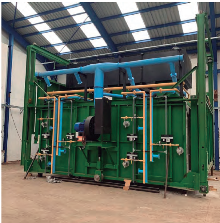
Forn de cocció i transformació del fibrociment. Imatge cedida per Thermal Recycling per Calmag
