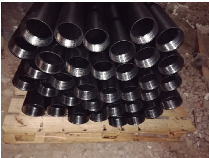
Canonada d'acer estructural matxambrat de diàmetre 60,3 fins a 114,3 mm (Fig. 3)
