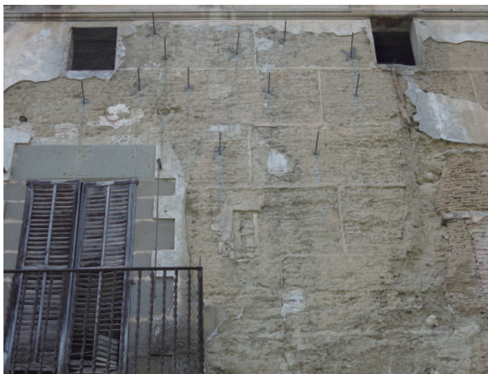
Campanya d'assaig d'extracció d'ancoratges de cara al travament de murs i forjats
