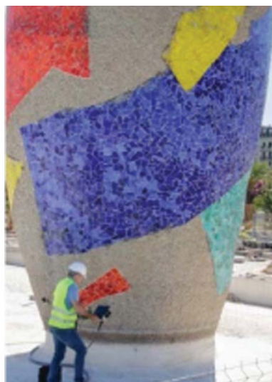
Treballs de recollida d'informació i anàlisi de les dades sobre la fonamentació de l'escultura i la seva estabilitat al llarg de tot el període de desenvolupament dels treballs
