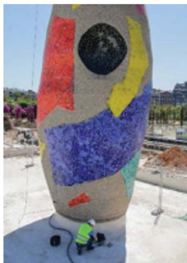
Treballs de recollida d'informació i anàlisi de les dades sobre la fonamentació de l'escultura i la seva estabilitat al llarg de tot el període de desenvolupament dels treballs
