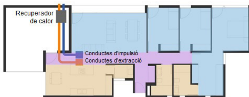
Fig. 11.- Components bàsics d'una ventilació mecànica controlada de doble flux
