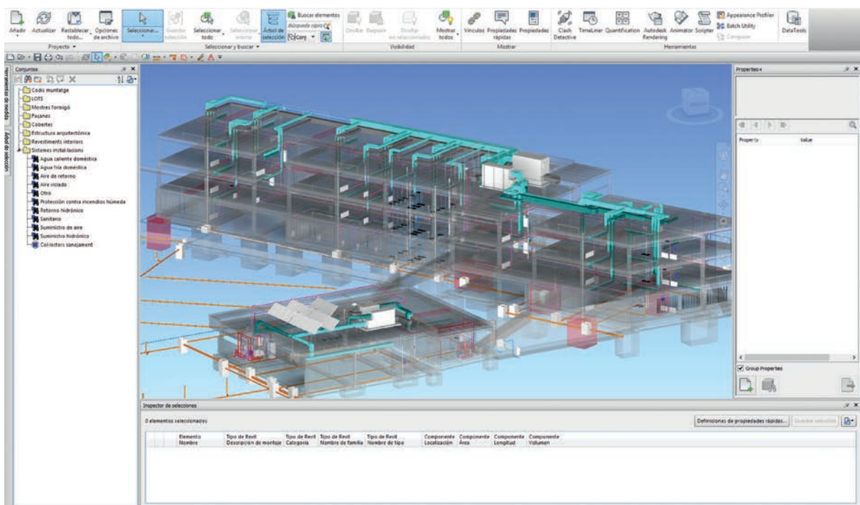
Model federat d'instal·lacions i estructura
