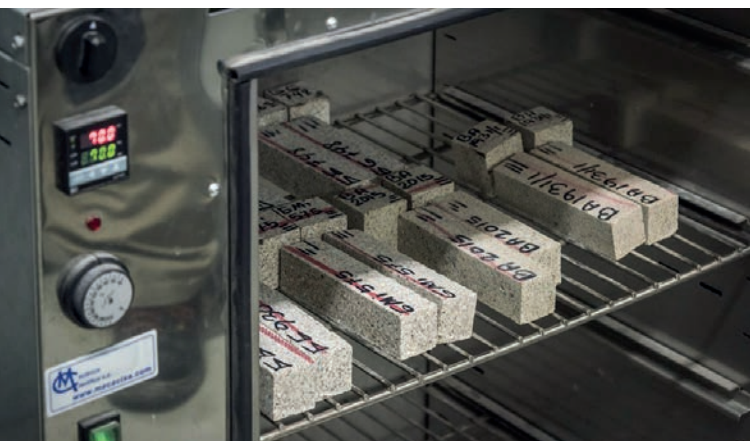
Provets cúbiques i primàstiques sotmeses a control i procés de tall per a la regularització dels blocs
