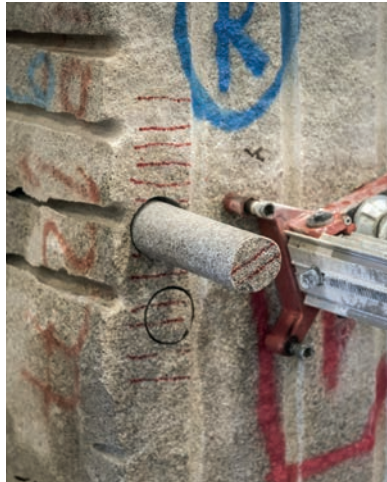
Testimoni cilíndric per als assaigs de resistència i classificació de les peces
