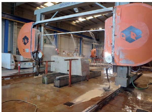
Provets cúbiques i primàstiques sotmeses a control i procés de tall per a la regularització dels blocs
