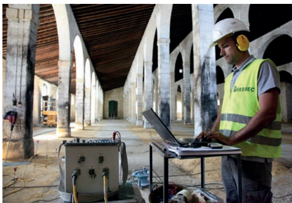
Control de l'obra mitjançant tomografia elèctrica 3D
