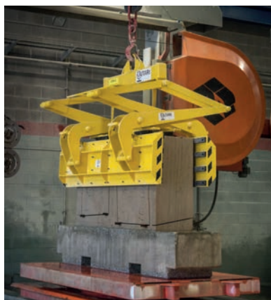
Transport de la peça i procés d'extracció mecànica de la proveta
