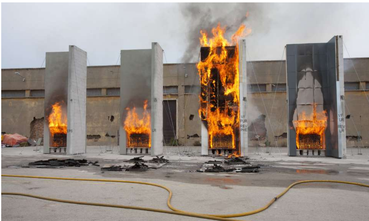
Assaig a gran escala amb diversos sistemes de façana muntats
