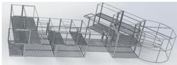
Figura 16 Esquema de l'estructura metàl·lica de l'edifici, basada principalment en contenidors marítims
