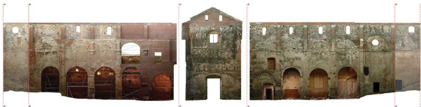
Aixecament de les parets perimetrals de l'església del convent
