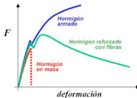
Figura 4a i 4b 4a. Assaig flexió proveta 160x40x40mm 4b. Comparativa de comportament post fissuració ©: Oriol París
