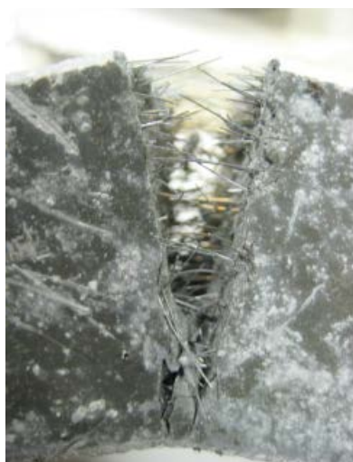
Figura 4a i 4b 4a. Assaig flexió proveta 160x40x40mm 4b. Comparativa de comportament post fissuració ©: Oriol París
