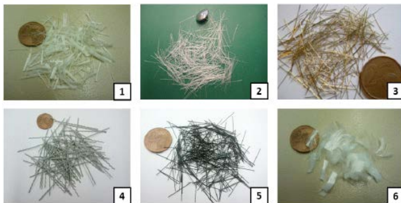
Figura 5 Diferents tipus de fibres que poden incorporar-se al formigó 1.-Fibra de vidre; 2.-PVA (alcohol de polivinil) 3.-Acer; 4 i 5.- PE/PP (poliolefina); 6.- Polipropilè ©: Oriol París
