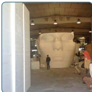
Recerca d'industrialització per tal de poder fabricar les peces singulars d'encofrats.
