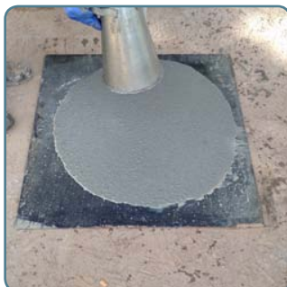
Dosificació específica de formigó autocompactant.
