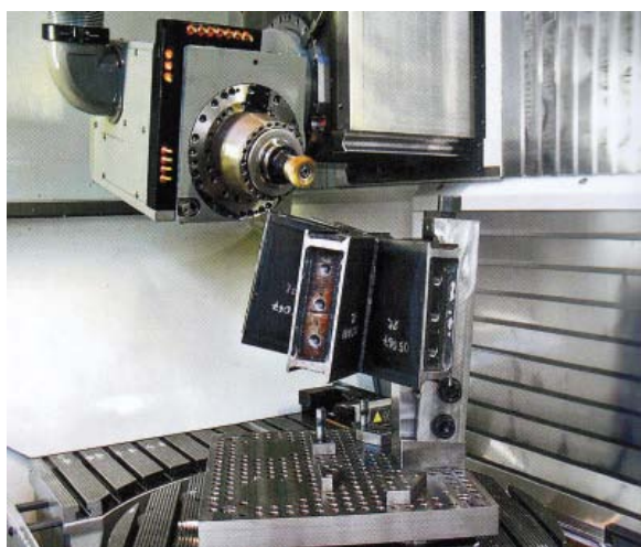
FABRICACIÓ I MUNTATGE DE NUSOS PEL PROJECTE DE WESTFIELD (LONDRES 2008). INNOVATIVE DESIGN+CONSTRUCTION. ED. DETAIL
