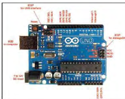
FIGURA 11.- ARDUINO UNO REV3. LA UNITAT DE CERVELL DEL NODE URBÀ
