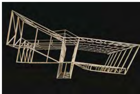
MAQUETES DE CADA UN DELS VOLUMS ON ES PODEN VEURE LES GELOSIES SUPERIORS I ELS ARRIOSTRAMENTS EN CADA ANGLE.
