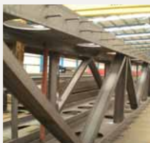
VISTA D'UN DELS CONJUNTS ACOBLATS. EN AQUEST CAS ES TRACTA DELS TRAMS EXTREMS DEL FORJAT INCLINAT DE LA SALA D'ACTES ON HI HA UNA SÈRIE DE BIGUES DE LLIGAT ENTRE LES BIGUES PRINCIPALS O BIGUES BOYD
