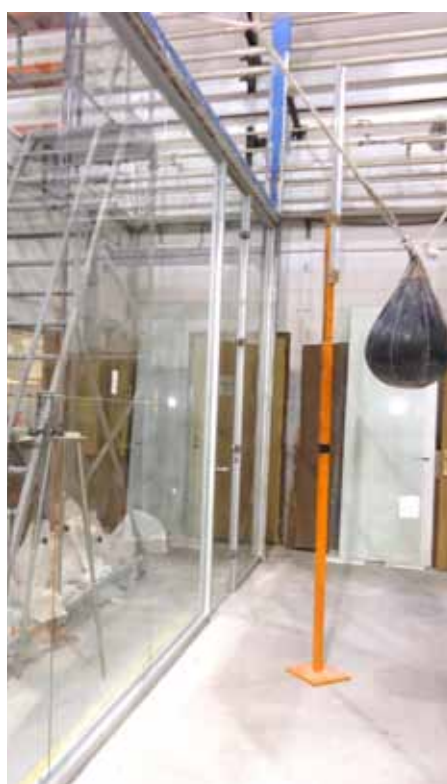
SEQÜÈNCIA D'ASSAIG DE RESISTÈNCIA DAVANT DE CÀRREGUES DINÀMIQUES D'UN ENVÀ VIDRIAT
