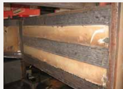
S'OBSERVA LA PEÇA ACABADA AMB LA QUANTITAT DE CORDONS EN SUPERFÍCIE QUE QUEDEN EN EL PUNT MÉS OBERT DEL BISELL
