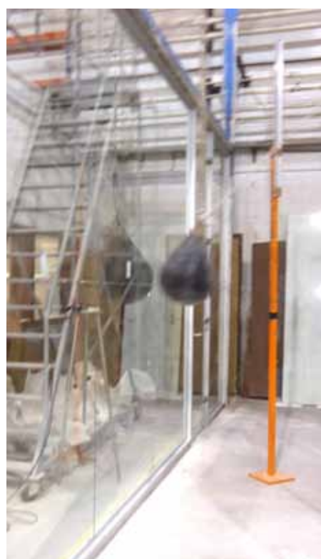
SEQÜÈNCIA D'ASSAIG DE RESISTÈNCIA DAVANT DE CÀRREGUES DINÀMIQUES D'UN ENVÀ VIDRIAT
