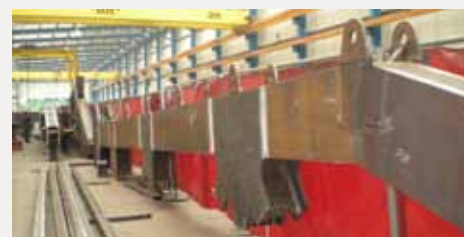
VISTA D'UNA DE LES BIGUES INFERIORS DE LA VOLADA 1 DEL NIVELL +29,86. SÓN LES PRIMERES PECES A COL·LOCAR, LES QUALS VAN ESTINTOLADES A L'ESPERA D'ACOBLEAR AMB EL PRIMER MÒDUL QUE RECUILL TOT ELS ANCORATGES. A LA VEGADA, AQUESTA BIGA ARMADA PORTA LA PREPARACIÓ D'UN TIRANT D'UNA PLANTA INFERIOR PENJADA, LA DEL NIVELL +24,74, SALA D'EXPOSICIONS
