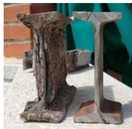
EXPANSIÓ DE LA SECCIÓ D'UN PERFIL A CAUSA DE L'OXIDACIÓ I EXFOLIACIÓ
