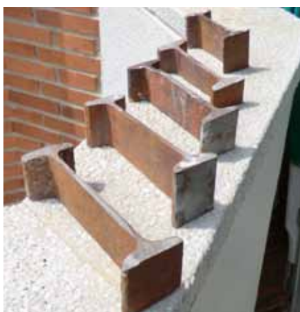
SECCIONS REALS DE PERFILS D'ALA ESTRETA
