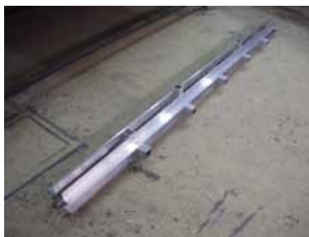
FIG. 1. BARRA COMPOSTA A PARTIR D'ANGULARS I TUBS
