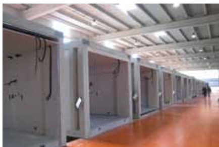
SISTEMA D'EDIFICACIÓ MODULAR INDUSTRIALITZADA COMPACT HABIT
