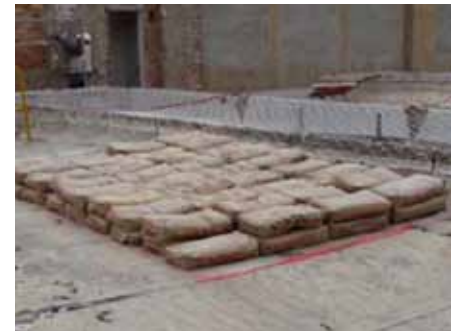
PER DETERMINAR LA SEGURETAT D'UN SOSTRE DE BIGUETES, SOVINT CAL PROCEDIR A VALORAR-LO EN CONJUNT, MITJANÇANT MODELS D'ANÀLISI MÉS O MENYS AJUSTATS, O A PARTIR DE PROVES DETERMINISTES ADAPTDES A CADA CAS. FONT: LABORATORI DE MATERIALS, EPSEB
