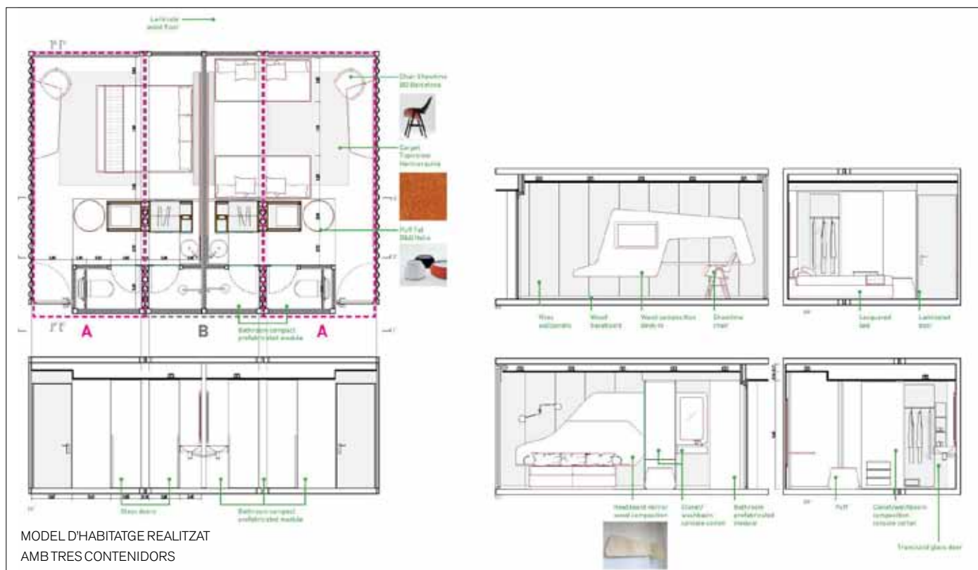
ESQUEMA D'APROFITAMENT D'UN CONTENIDOR DE MERCADERIES I D'UN EXEMPLE DE COMBINACIÓ PER A L'EDIFICI DE MATARÓ
