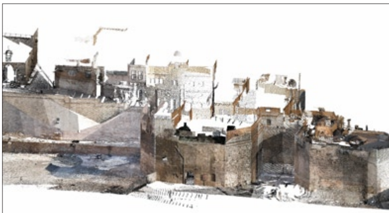
UNA DE LES VISTES GENERALS GENERADES AMB EL NÚVOL DE PUNTS OBTINGUT AMB L'SCAN-LÀSER. TOTA LA INFORMACIÓ ÉS MÈTRICA
