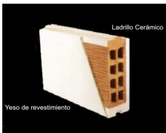
ELS NOSTRES MAONS TABIYESO® CONSTEN D'UNA ÀNIMA DE MAÓ CERÀMIC BUIT, REVESTIT DE GUIX PER LES SIS CARES I ENCADELLAT EN LES CARES MENORS PER FACILITAR-NE EL MUNTATGE
