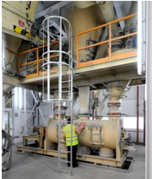
MÀQUINA MESCLADORA, ON ES BARREGEN TOTS ELS COMPONENTS DE CADA MATERIAL QUE CAUEN PELS TUBS
