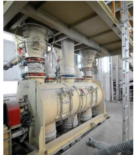
DETALL DE LA MESCLADORA, MÀQUINA FONAMENTAL PER LA QUALITAT DEL PRODUCTE
