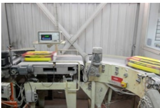
PESAT DE CADA SAC, PER COMPROVAR-NE EL CORRECTE ENSACAT
