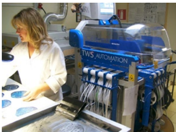
SALA DE MUNTATGE SMT, ROBOT, SERIGRAFIA I FORN.(SERIGRAFIANT)
