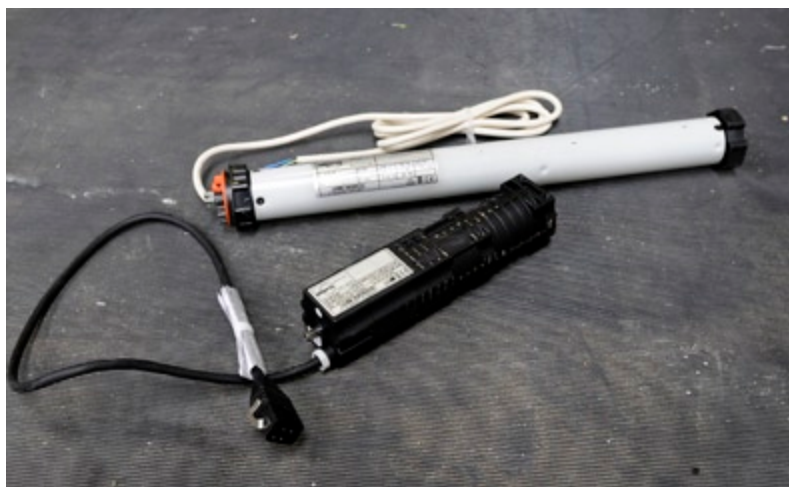
UNITATS DE REGISTRE I MOTOR, A PUNT PER SER PORTAT A L'OBRA
