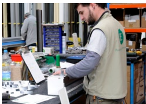
MUNTATGE DEL CALAIX D'ALUMINI QUE AMAGARÀ LA PERSIANA REPLEGADA I L'AUTOMATISME
