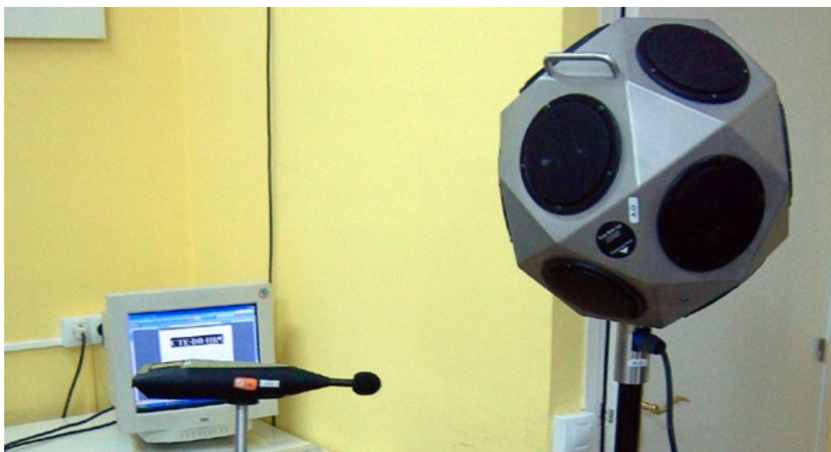
FIGURA 1. MESURA D'AÏLLAMENT IN SITU
