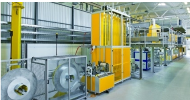
1. VISTA DEL TREN DE PINTAT DE LES LAMEL·LES. EN PRIMER TERME LES BOBINES PER ENTRAR AL PROCÉS DE PINTAT
