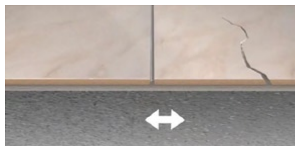
ELS MOVIMENTS DEL SUPORT, A VEGADES PODEN PROVOCAR RUPTURES/FISURES EN EL PAVIMENT CERÀMIC
