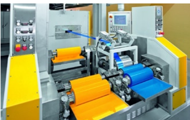
2. LA CUBETA BLAVA ACTIVA, LES DUES DE COLOR GROC, EN ESPERA, PODEN DESPLAÇAR-SE FINS A LA LÍNEA DE TRACCIÓ DE LA BANDA PER COMENÇAR A PINTAR EN AQUEST COLOR
