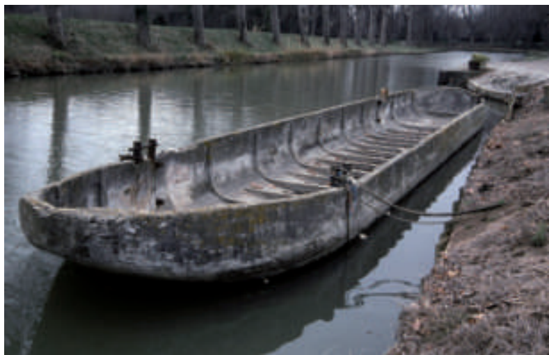
FIG. 3. BARCA DE FORMIGÓ ARMAT AL CANAL DU MIDI. CAL OBSERVAR EL SISTEMA DE COSTELLES CENTRALS PER DONAR RIGIDESA A LA CURVATURA
