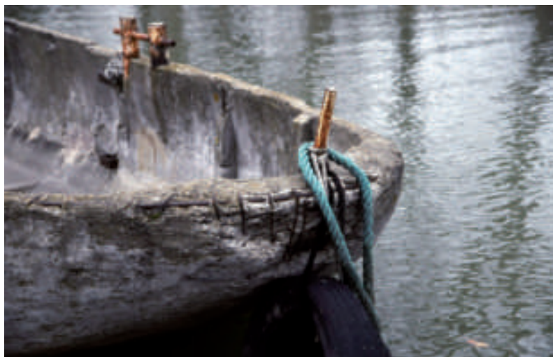
FIG. 4. CAL OBSERVAR ELS MATEIXOS DEFECTES QUE ELS FORMIGONS APLICATS A L'EDIFICACIÓ I A L'OBRA CIVIL.
