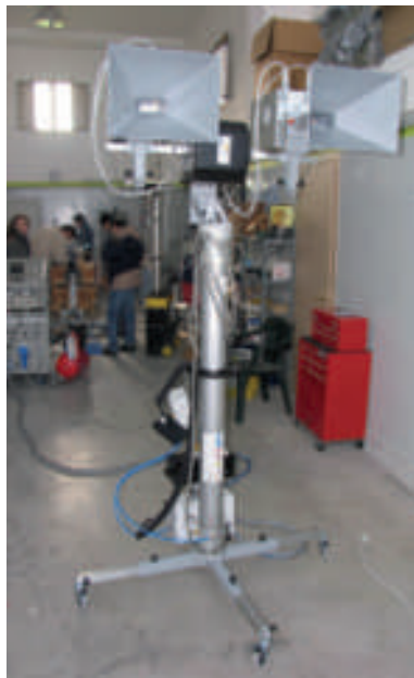
MÀQUINA DE MICROONES PER AL TRACTAMENT D'ESTRUCTURES DE FUSTA I PAVIMENTS
