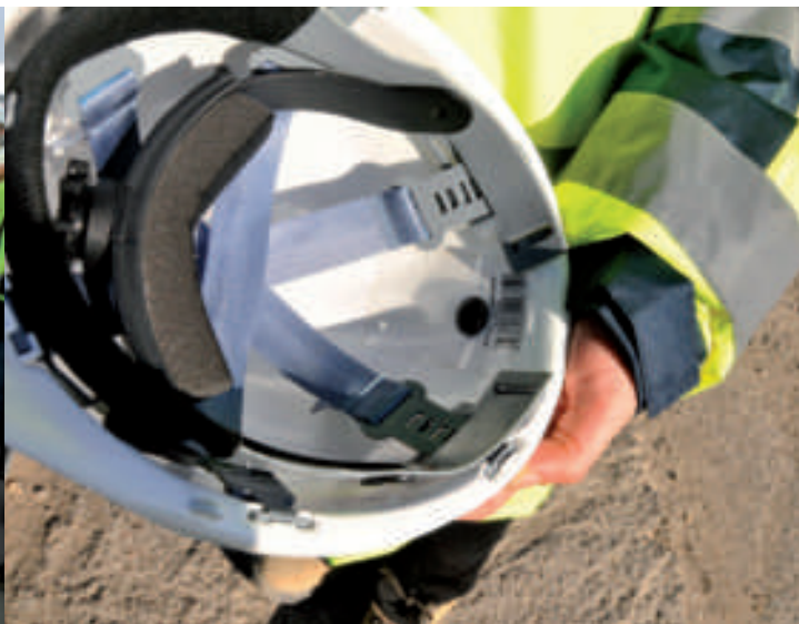
ELS TREBALLADORS S'IDENTIFIQUEN AMB UN XIP INSTAL·LAT AL CASC DE SEGURETAT QUAN ACCEDEIXEN AL RECINTE DE LES OBRES
