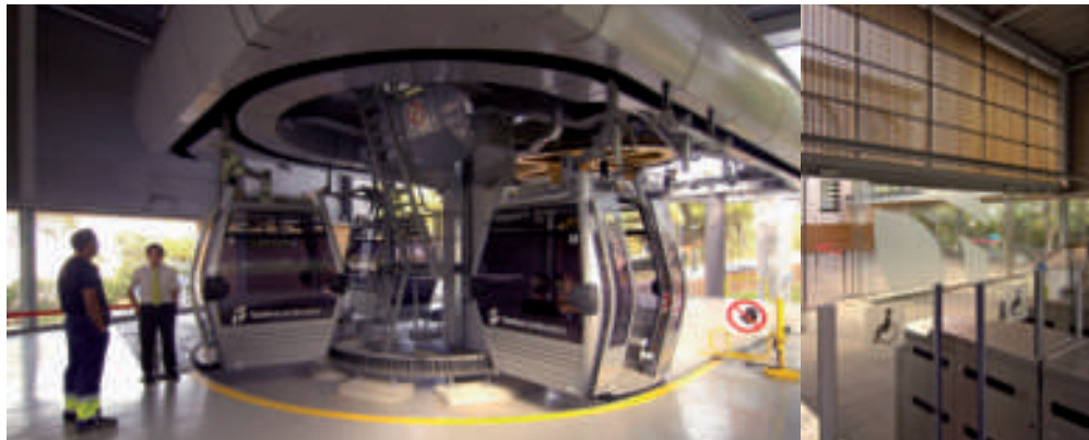
L'ACCÉS A LES CABINES ÉS FÀCIL PERQUÈ EL TERRA QUEDA A LA MATEIXA ALÇADA DE LES ANDANES I TENEN PORTES AUTOMÀTIQUES
