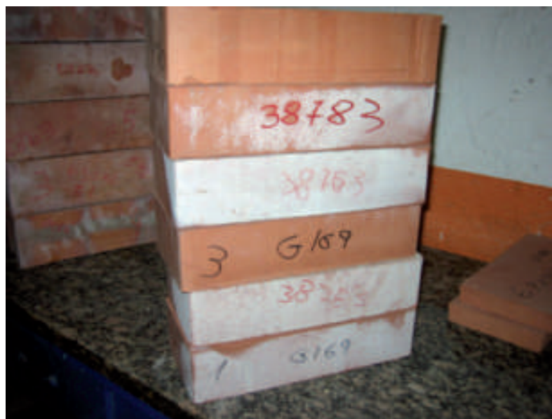
RESULTAT EN CERÀMIQUES DESPRÉS DE L'ASSAIG D'EFLORESCÈNCIES
