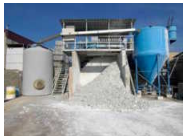
20. TRACTAMENT PER AL RECICLATGE DE LES SOBRES DE FABRICACIÓ NO REAPROFITABLES. UN COP TRACTADES S'APROFITEN PER A ALTRES USOS DE MARBRERIA
