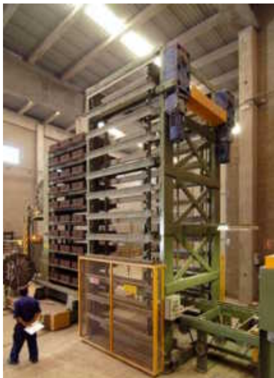
12. MÀQUINA D'APILONAT I DE TRANSPORT DELS BLOCS
