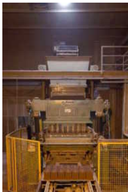
9. EL MATERIAL S'ABOCA DES DE DALT ALS MOTLLES I ES PREMSA
