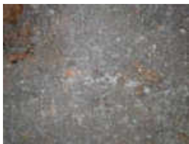
MICROFOTOGRAFIES DE LA SUPERFÍCIE CERÀMICA ABANS DE LA NETEJA
