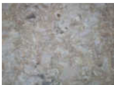
MICROFOTOGRAFIES DE LA SUPERFÍCIE PÈTRIA DESPRÉS DE LA NETEJA SELECCIONADA
