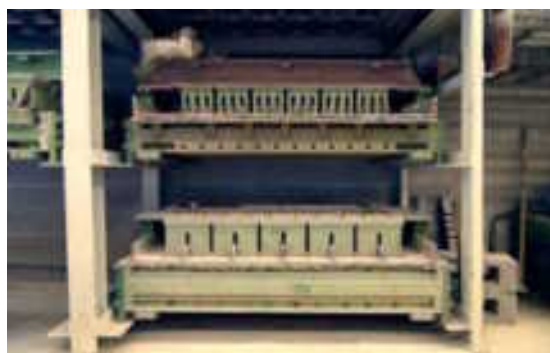
10. MOTLLES PER LA PREMSA DE DIFERENTS FORMES
