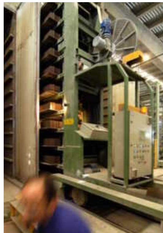
13. BLOCS ENTRANT A LA CAMBRA DE CURACIÓ
