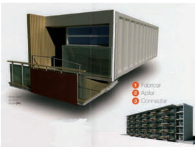
SISTEMA DE CONSTRUCCIÓ MODULAR COMPACT HABIT
