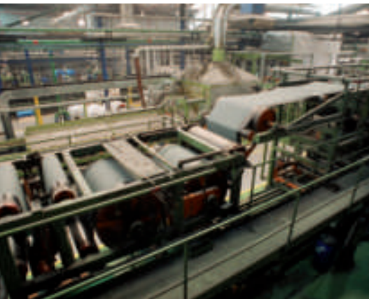
10. AL FINAL DEL TREN, UNS CILINDRES AMB AIGUA FREDA ACABEN DE REFREDAR LA LÀMINA. OBSERVEU LA ZONA D'ACUMULACIÓ ABANS DEL TALLAMENT I ENROTLLAMENT A L'ESQUERRA DE LA IMATGE. ELS CORRONS PUGEN I BAIXEN PER TENIR MÉS O MENYS LONGITUD DE LÀMINA ACUMULADA.
