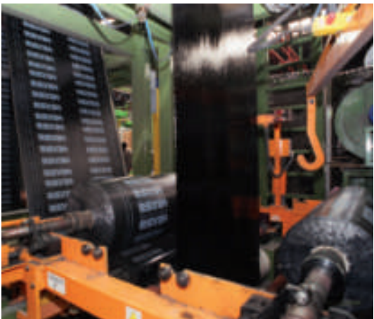
9. EL MATERIAL GAIREBÉ ACABAT, AL FINAL DEL TREN DE FABRICACIÓ AMB ELS FILMS DE PROTECCIÓ QUE PERMETEN QUE EL BETUM NO S'ENGANXI ALS CORRONS DE TRACCIÓ I MANIPULACIÓ DE LA LÀMINA.
