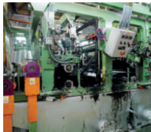
7. CUBETES O BASSES D'IMPREGNACIÓ, ON REALMENT ES FABRICA EL PRODUCTE. ELS CORRONS DE GALGATGE DE LA LÀMINA SÓN A L'ESQUERRA DE LA IMATGE
