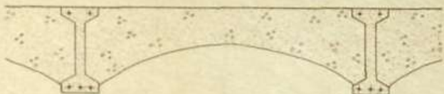
con encofrado recuperable
