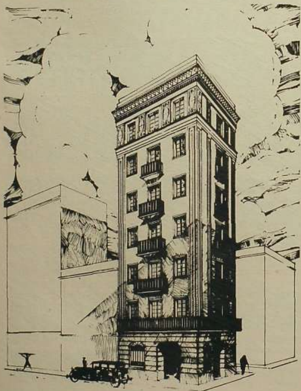
Perspectiva edificio Barceloneta. La esbeltez de la "torre" proyectada en la Plaza de San Miguel en la Barceloneta, hace indispensable el zunchado eficaz de la caja de muros portante. A la altura de los forjados de las plantas impares se dispone un zunchado de atado en todo el perímetro del edificio.
