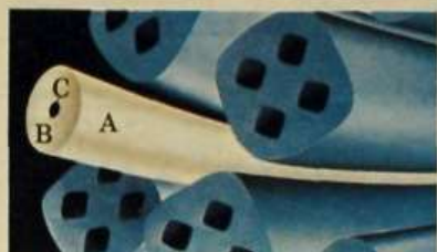
Fibra ANTRON III HF. A) Elemento antiestático. B) Membrana de nylon. C) Alma de carbono.
