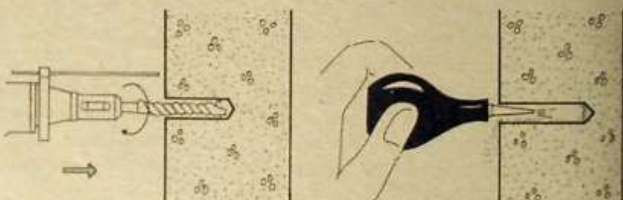
7 Fijación de expansión mecánica por anillos
