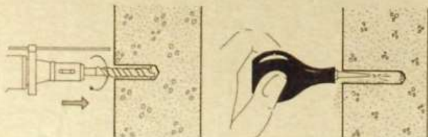
5 Fijación de expansión manual por cono
