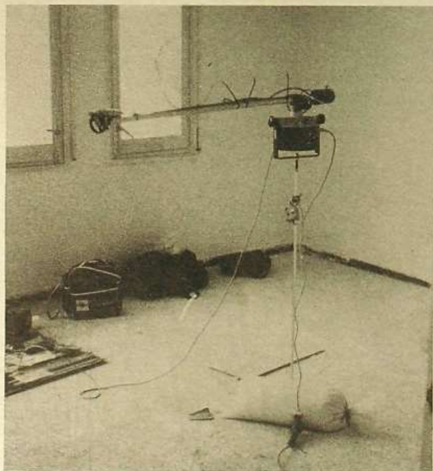
28 Medición de los niveles de inmisión, estando las ventanas cerradas.
