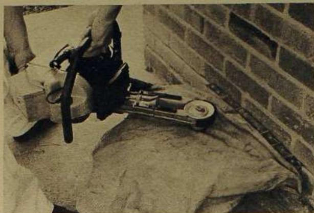
4 Sierra mecánica con extractor de polvo mediante vacío.
