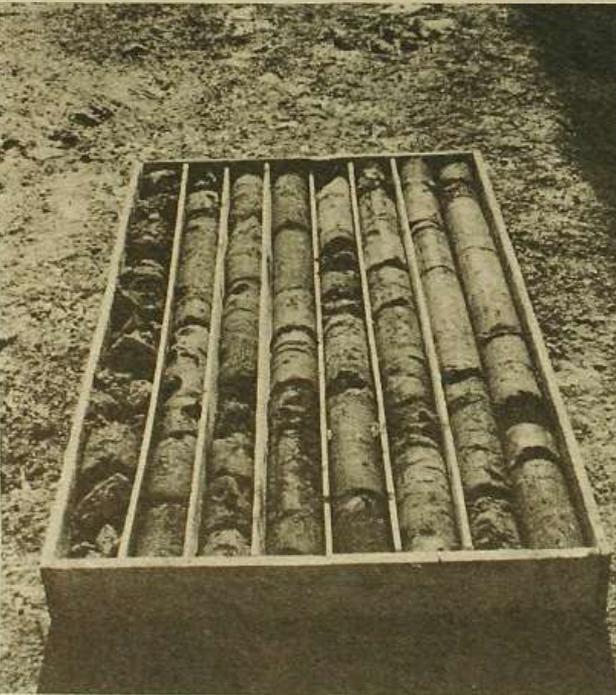
7 Muestras extraídas durante la prospección de un suelo. La ordenación de las mismas según la profundidad, permite conocer directamente la secuencia real de los estratos que lo componen.
