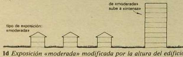
1 La exposición primitiva del solar debe modificarse según la topografía o la altura de los edificios.
