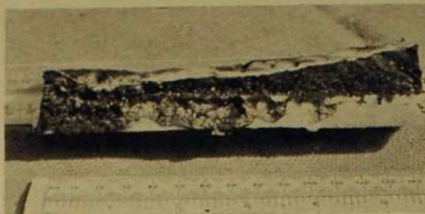
8 Mala adherencia entre un sellante polisulfuroso y hormigón, ya que este último se ha imprimado con betún, impidiendo así, que se produzca una reacción química en la superficie de la masilla.
