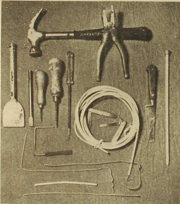
5 Conjunto de herramientas convencionales y no convencionales para operaciones de examen y apertura de huecos.
