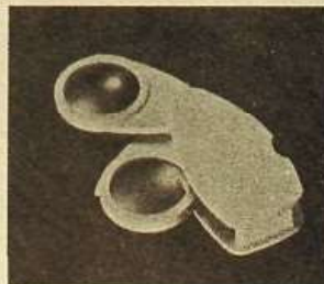
8 Higrómetro giratorio con termómetro de burbuja húmedo y seco, para la determinación de la humedad relativa.
