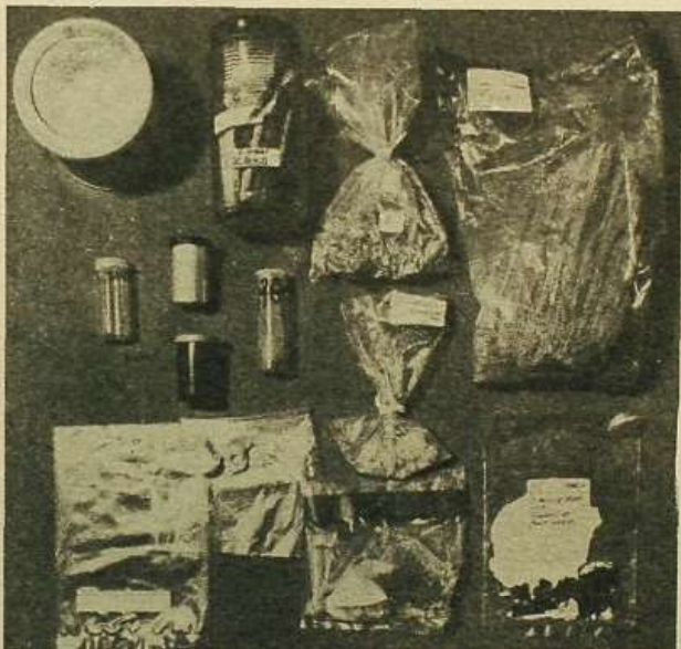
7 El polvo y otras muestras y probetas de materiales, se guardan en botellas o bolsas de plástico como evidencia, abriéndose durante la investigación o para su análisis.
