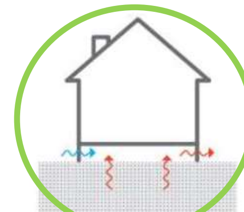
Cambra d'aire ventilada
