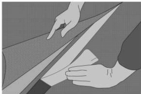
Figura 1 - Ejemplo de solape entre dos láminas
